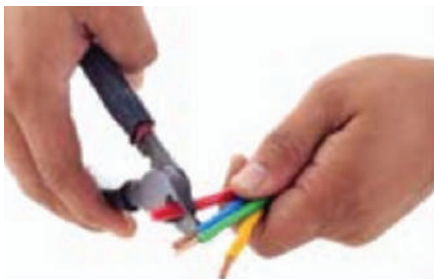
වයර් ස්ට්‍රිපර් (wire stripper) භාවිතයෙන් පරිවරණය ඉවත් කිරීම
